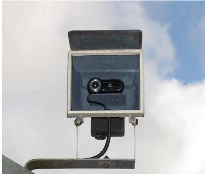
Die [Logitech](#) WebCam, Typ QuickCam Pro 9000 ist zum Schutz vor Feuchtigkeit in einem Halogen-Außenstrahler-Gehäuse untergebracht.
