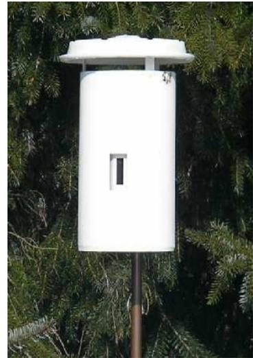
Temperatursprünge bei wechselnder Bestrahlung. Hinter dem kleinen Sichtfenster mit vorgesetzter Glasplatte befindet sich die Solarzelle, mittels derer die Akkupufferung weiterhin gewährleistet wird.
