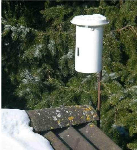
Der Außen-Temperatur- / Feuchtesensor S 2001 A wurde in einer Höhe von zwei Metern angebracht. Damit der Außensensor nicht direkt durch Sonnenbestrahlung aufgeheizt werden kann, wurde er in ein Kunststoffrohr eingebaut, mit einer Haube und einem ausreichenden Luftspalt versehen, sowie weiß lackiert. Durch den Kamineffekt entsteht keine Stauwärme und die Temperaturmessung ist nahezu stabil, ohne große
